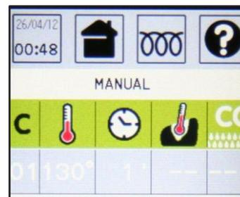
После этого выбрать значок изменения температуры (например, 150 °). Измените значение параметра вращением ручки, нажать «ВВОД» или нажать на соответствующую экранную кнопку.
