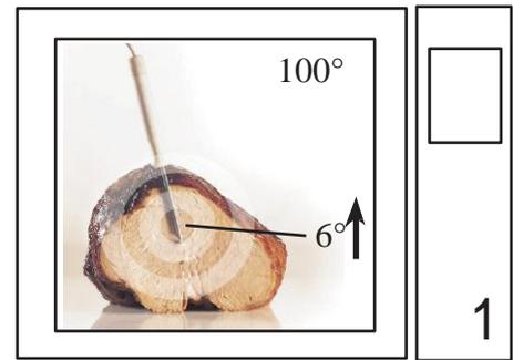
После запуска температура шкафа поднимается до  $100^{\circ}$ ; одновременно повышается температура, регистрируемая термощупом (этап 1). Функция  $\Delta T$  начинает действовать автоматически после того, как температура термощупа достигнет отметки  $6^{\circ} + \Delta T$ ,  $6^{\circ} + 30^{\circ} = 36^{\circ}$  (этап 2).
