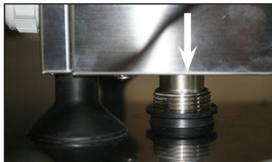
Снять крышку с штуцера печи.
