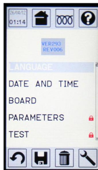
Функции «TEST» (ПРОВЕРКА), «PROBES» (ТЕРМОЩУП), «DELETE RECIPES» (УДАЛЕНИЕ РЕЦЕПТОВ), «DELETE НАССР» (УДАЛЕНИЕ ДАННЫХ НАССР) и «MODEL» (МОДЕЛЬ) защищены паролем, на что указывают соответствующие символы справа. Эти опции предназначены для использования исключительно специалистами.
