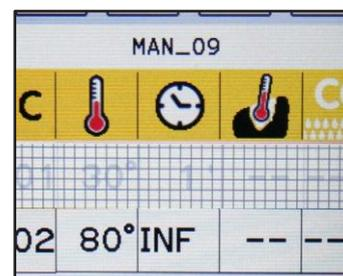
**ПРИМЕЧАНИЕ:** имеется возможность изменить заданные значения параметров приготовления после запуска программы, когда изделие уже работает (как и в вышеописанных случаях, это делается с помощью сенсорного дисплея, вращением ручки и с помощью функции ввода). После завершения программы измененные значения сохраняются в локальной памяти, чтобы сохранить их выберите значок «Сохранить» (см. главу «Сохранение программы»).
