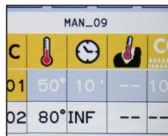
Если длительность последнего цикла является конечной, после завершения всех циклов на табло выводится сетчатый исходный экран, и раздается длительный звуковой сигнал, уведомляющий оператора о завершении программы.
