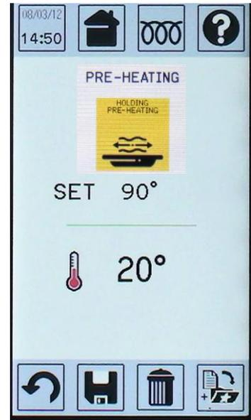
Шкаф в этот момент должен находиться в бездействующем состоянии (STOP); при нажатии кнопки «ВВОД» на табло появится всплывающее окно. Теперь, используя регулятор, можно задать требуемую температуру прогрева (к примеру, 80°) и подтвердить выбранное значение, нажав «ВВОД» или нажав на экранную кнопку еще раз.
