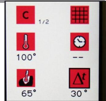
Продукт помещают в шкаф, втыкают в него термощуп и закрывают дверцу. Далее необходимо нажать кнопку «ПУСК/СТОП» для запуска программы (допустим при этом, что исходная температура продукта составляет  $6^{\circ}$ ).
